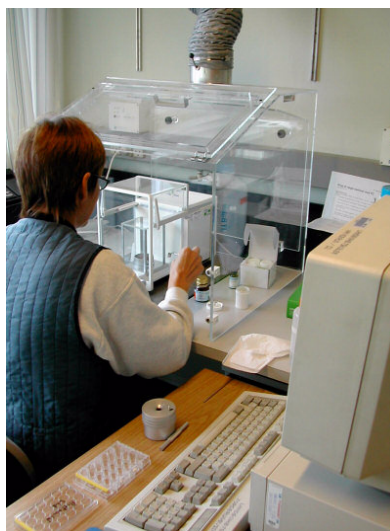
Billede 4.1. Prøver vejes på Mettlervægt (foto: Hafðís Hauksdóttir)
