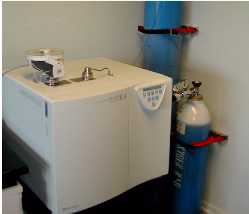
Billede 4.2.. Grundstof analysator (foto: Hafþís Hauksdóttir)
